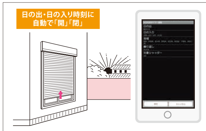
時刻は一ヶ月ごとに自動変更(おこのみタイマーとの併用も可能)。
